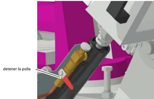
Imagen 4-1: Alimentación hidráulica
